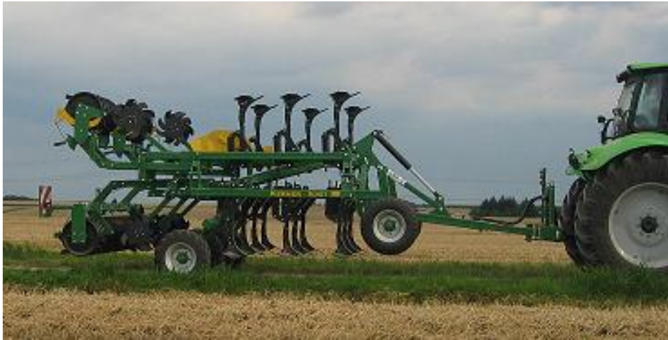
1. Tasträder, 2. 3-teilige Flügelscharen, 3. Fahrwerk, 4. Sternverteiler, 5. Crackerwalze
