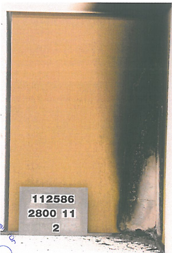
Bild 3: Oberfläche des breiten Probenflügels nach dem SBI-Versuch
