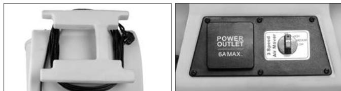
Questo apparecchio offre la possibilità di avvolgere il cavo sulla maniglia portante. Il TFV 30 S dispone inoltre di una presa di servizio, con la quale si può far funzionare, tramite la stessa presa, un ulteriore apparecchio impilato, per es. un ulteriore TFV 30 S. Questa presa è funzionante finché il primo apparecchio è collegato - non è necessario che sia acceso.
