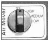
TFV 30 S käynnistetään väänökytkimellä. Valitse haluamasi puhallusteho:
