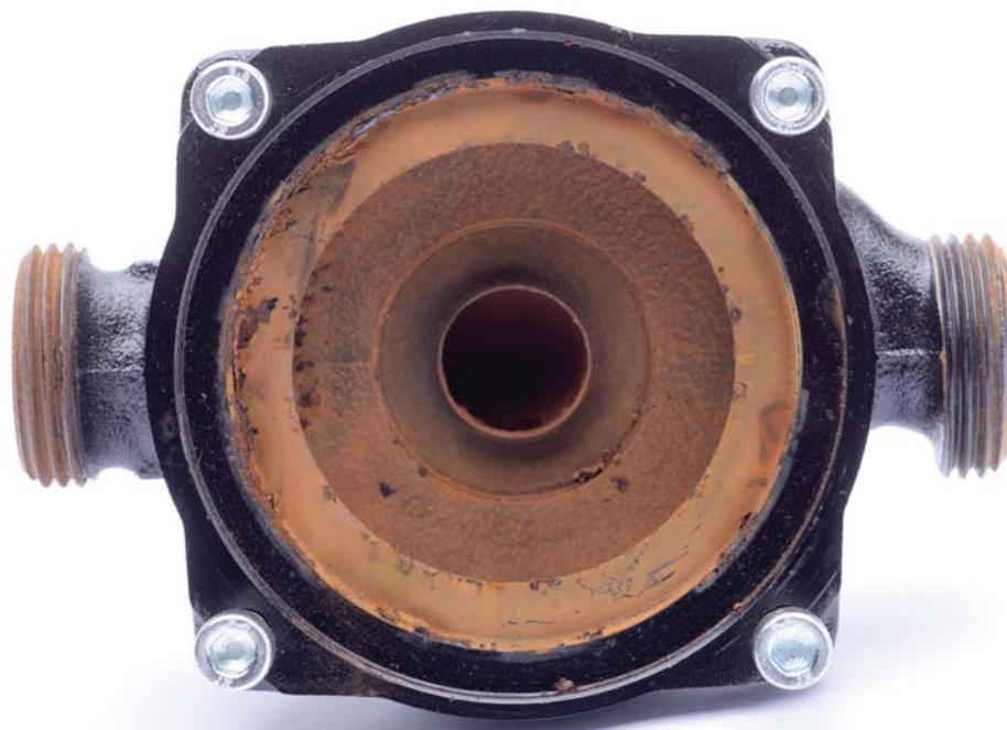
Die Maßnahmen zur Vermeidung von Schäden durch Korrosion und Verkalkung ziehen sich durch alle Phasen der Errichtung und des Betriebs einer Heizungsanlage. Von der Planung über die Installation und Inbetriebnahme bis zur Wartung gilt es, die potenziellen Gefahren zu erkennen und damit Schäden an der Anlage zu verhindern.
