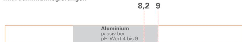
Der pH-Wert ist ein dimensionsloses Maß für den sauren, neutralen oder basischen Charakter von Flüssigkeiten. Für Heizwasser gelten enge Grenzen, um Korrosionsprozesse zu vermeiden. Während für Eisen und Kupfer ein oberer Grenzwert von 10 zulässig ist, darf der pH-Wert bei Aluminiumlegierungen nicht über 9 liegen. Edelstahl ist dagegen in allen Bereichen passiv.
