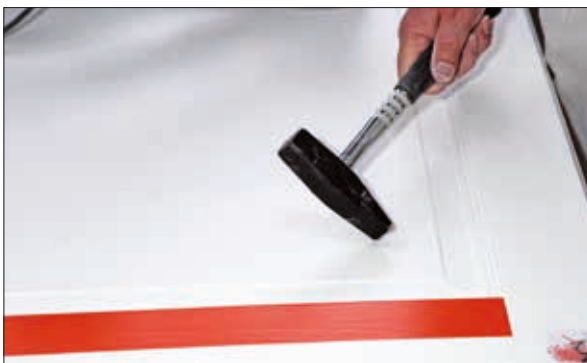
Mit dem Hammer wurden die Oberflächen beschädigt. Die rechte Abbildung zeigt ein fertig geschliffenes Türblatt, dessen obere Füllung oben eine 1K- und rechts eine 2K-Spachtelfläche aufweist. Im linken unteren Füllungsbereich ist die Schadstelle mit Isolierlack ausgebessert, zudem ist die durchgeschliffene rohe Stelle sichtbar.
