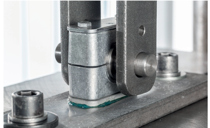
Zugversuch der STAUFF Bond Klebplatte (Typ SBP) mit Klebemittel (Typ CB420-50E).
