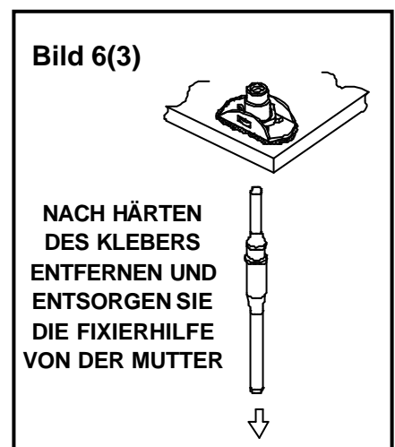
BILD 6. MONTAGE VON STANDARD KÄFIGMUTTERN
