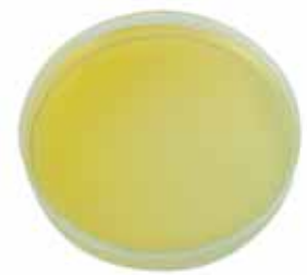
Petrischale mit Nährboden (YPD-Agar) mit FEMA®-Schimmelpilz-Entferner behandelt. Auch nach 15 Tagen keine Schimmelpilzkolonien.
