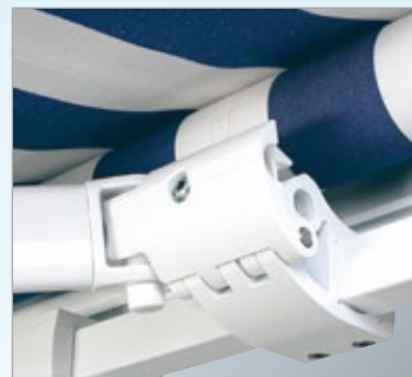
Kippgelenkarmlager mit selbstverriegelnder Hochschlagsicherung. Kippteile gesenkgeschmiedet
