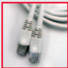
Datenkabel zwischen Bedienteil und Luftschleier
