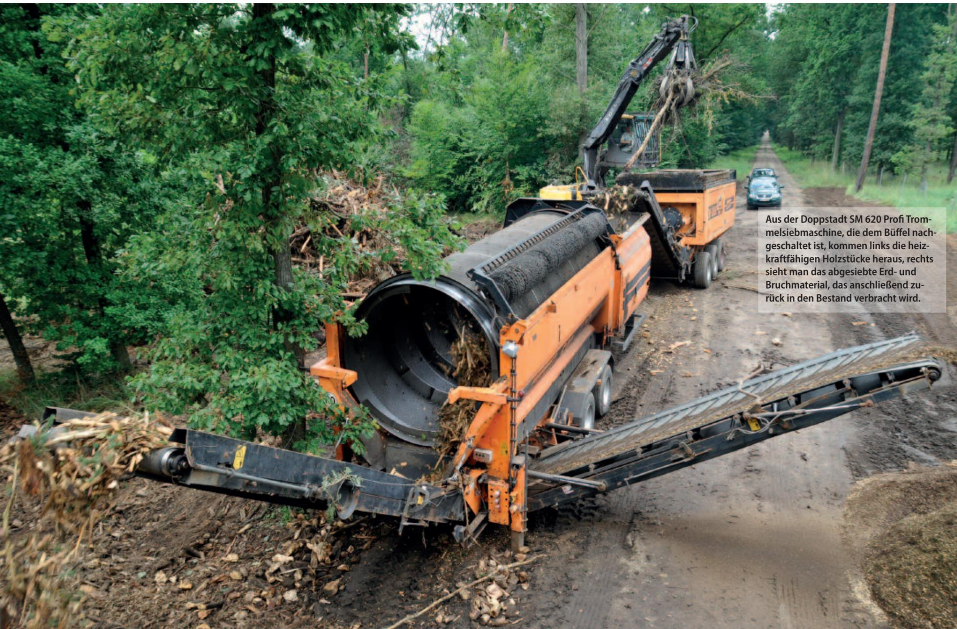
Aus der Doppstadt SM 620 Profi Trommelsiebmaschine, die dem Büffel nachgeschaltet ist, kommen links die heizkraftfähigen Holzstücke heraus, rechts sieht man das abgesiebte Erd- und Bruchmaterial, das anschließend zurück in den Bestand verbracht wird.
