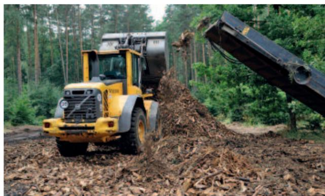
Oben: Das vom Brecher erzeugte Material wird mit dem Radlader aufgeschichtet.
