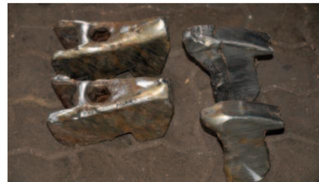
Oben: Die Zähne verschleifen recht schnell und werden von Friedrich Schulze bis zu drei mal wieder aufgepanzert. Dann müssen neue Zähne angeschafft werden.
