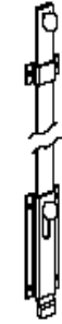
Art. 8651 zusätzlicher Riegel, 600mm lang, zur Sicherung nach oben, in Ladenfarbe, Bedienkugel schwarz
