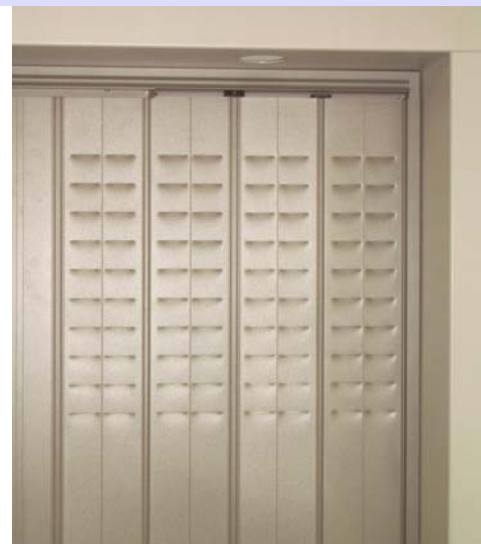
Art. 8611 10 Luftschlitze, beidseitig eingepägt, Raster 50mm, nach 100 mm von oben beginnend.
