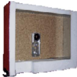
Sendzimir-verzinkter Stahlblechkasten, raumseitig geschlossen, an den beiden Außenseiten mit Putzträgern aus Hartschaumplatten (EPS / WI 035) mit UV-beständiger, gewebeverstärkter und frostsicherer Fassadenspachtel beschichtet (VWS-Qualität), an der Oberseite mit Styropor, mit Aluminium-Putzschiene (im Auflagerbereich ausgeklinkt) mit isolierten Spanplattenstirndeckel V100, Gurtaustritt-Grundkörper mit Putzkappe **einschl. geschlossenen Zargen isoliert.**
