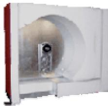
Sendzimir-verzinkter Stahlblechkasten, raumseitig geschlossen, an den beiden Außenseiten mit Putzträgern aus Hartschaumplatten (EPS / WI 035) mit UV-beständiger, gewebeverstärkter und frostsicherer Fassadenspachtel beschichtet (VWS-Qualität), an der Oberseite mit Bitumenfilz, **mit Isolierkern aus Polystyrol-Formteil**, mit Aluminium-Putzschiene (im Auflagerbereich ausgeklinkt), isolierte Metallstirndeckel, Gurtaustritt-Grundkörper mit Putzkappe **einschl. geschlossenen Zargen isoliert.**
