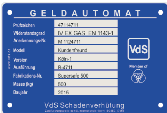
Bild 7-5: Anerkennungsplakette für Wertbehältnisse für Geldautomaten in der klassischen sowie in der Darstellungweise bei Zertifizierung im Rahmen der EFSG
