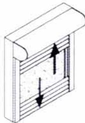
Aufzugsgurt immer senkrecht und gleichmäßig nach unten bzw. aus dem Wicklergehäuse ziehen.
