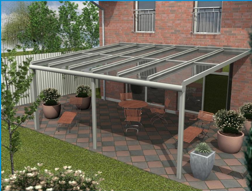
Unser TC 028 Kaltdach besteht aus stranggepressten Aluminiumprofilen und ist je nach statischen Erfordernissen mit innenliegender Stahlarmierung ausgestattet. Eine hochwertige Pulverbeschichtung sorgt für lange und wartungsfreie Lebensdauer. Die Standardfarben sind weiss RAL 9016 oder dunkelbraun ähnlich RAL 8077. Gegen Aufpreis sind sämtliche Standard RAL- Farbtöne lieferbar. Die Dacheindeckung erfolgt wahlweise mit 16mm Doppelstegplatten oder ESG- Einscheibensicherheitsglas.
