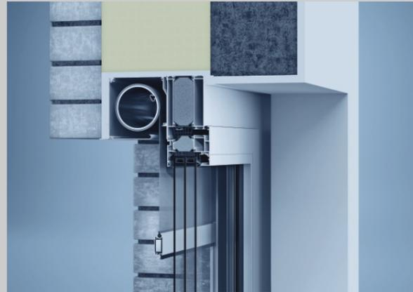
Durch die dickwandigen und speziell profilierten sowie strangepreßten Markisenkästen sind auch größere Anlagenbreiten problemlos realisierbar.
