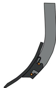
Scharspitze mit Federsteg am Sperrbolzen befestigt
