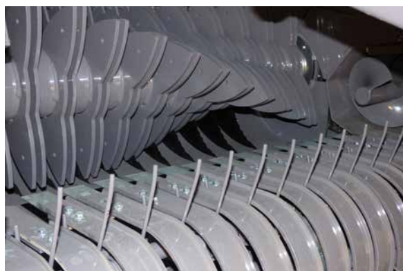
Schneidwerk mit Spiralrotor
