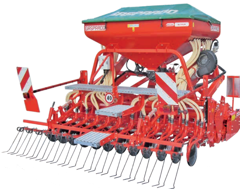
Kreiselegge DM RAPIDO + ALITALIA bis 200 PS (Abbildung zeigt aufpreispflichtiges Zubehö r)
