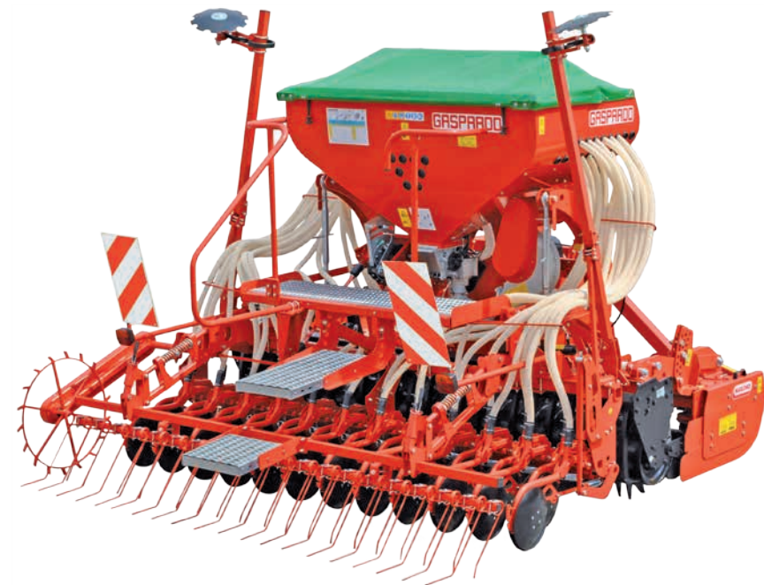
Kreiselegge DM CLASSIC + ALIANTE PLUS bis 180 PS (Abbildung zeigt aufpreispflichtiges Zubehör)
