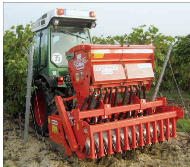
Mechanischer Antrieb über Walze
