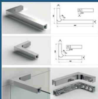
Da die Duschwannen selten im rechten Winkel zur Wand stehen, hat man jetzt die Möglichkeit, mit den verstellbaren Stabilisationswinkeln ( $90^\circ \pm 2^\circ$ ) von Pauli + Sohn die Glasseitenteile auf der Duschtasse oder auf dem Boden zu montieren. Die neuen Stabilisationswinkel gibt es für unterschiedlich große Seitenteile mit Schenkellängen von 180 und 280 mm und passend zu unseren Beschlägen in verschiedenen Oberflächen.
