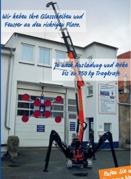
Je nach Ausladung und Höhe bis zu 750 kg Tragkraft.
