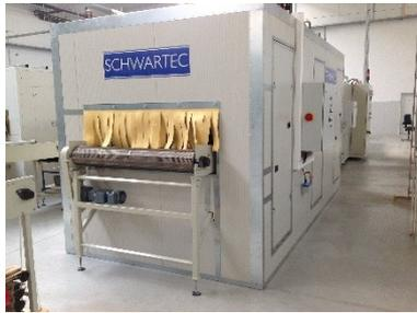
Die Montagezeit und Inbetriebnahme vor Ort nimmt lediglich einen Tag in Anspruch. Innerhalb dieser Zeit wird auch das Förderband in den Tunnel integriert. Maximale Breite des Tunnels sind 2,35 m, um mit Standard LKW transportieren zu können. Die Länge
