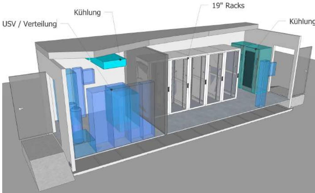
asfm-TMC als IT-Spezialcontainer-Modulraum, bestehend aus 2 asfm-TMC Typ 15s mit abgetrenntem Infrastrukturbereich und Eingangsschleuse:
