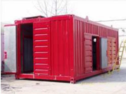
Container als Kaltwassersatz- oder Kompressorstation. Ein Teil der Dachgruppe für einfachere Montage und Wartung der eingebauten Technik komplett demontierbar.
