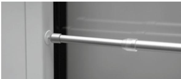
Unter Berücksichtigung der jeweiligen Glasbreite die Länge der Pinn-Stange durch einfaches Drehen anpassen, den Federmechanismus leicht zusammendrücken und anschließend zwischen den Glasleisten fixieren. Die beiliegenden Fixpunkte verhindern dabei Beschädigungen der Glasleisten. Pinn-Stangen sind geeignet für den Einsatz an geraden und leicht schrägen Glasleisten.
