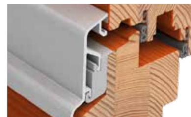
Die thermisch entkoppelte Wetterschutzschiene sowie unsere Aluminium-Vorsatzschalen sind diffusionsoffen. Dies verhindert Hinterfeuchtung und Kapillare.
