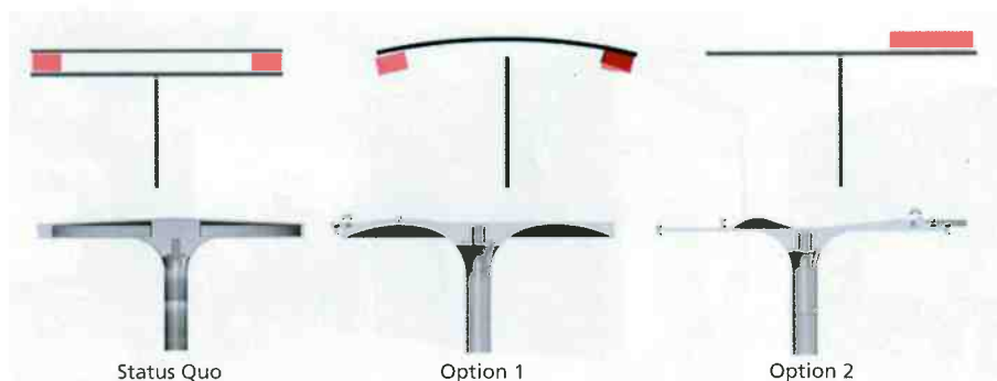
Bild 3: Konstruktive Formgebung eines kreisrunden Stützenkopfs – Prinzipdarstellungen
