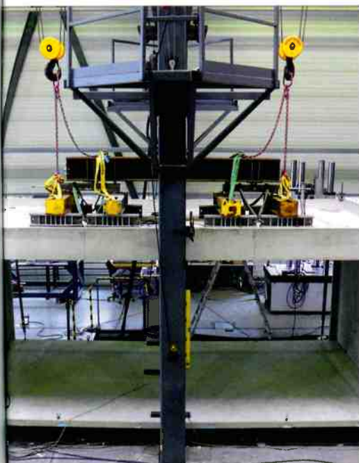
Bild 14: Bauteilversuche an Fertigteilgaragen aus Textilbeton
