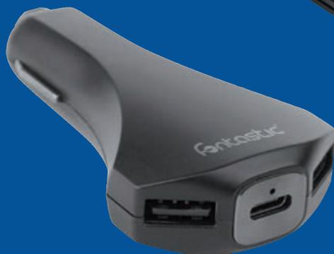
**Kfz-Ladeadapter Y** | Praktischer Y-Charger mit 3 Lademöglichkeiten | Schnelles und sicheres Aufladen | Geeignet für Smartphones und Tablets Eingangsspannung: 12–24 V DC | Ausgang Quick Charge: 3,6–12 V DC max. 3 A | Ausgang Smart-USB: 5 V DC max. 3A | Ausgang USB-Type-C: 5V DC max. 3 A | Ausgangsleistung: max. 30 Watt
