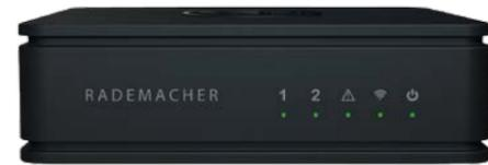
1. DuoFern USB-Stick einstecken und den HomePilot® mit dem beiliegendem LAN-Kabel an Ihren Internet-Router anschließen. Nun kann der HomePilot® bereits an das Stromnetz angeschlossen werden.
