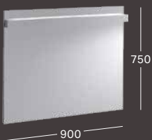
Lichtspiegeelement B 900 / H 750 / T 45 Leuchtelement vor Montage nach links oder rechts verstellbar Beleuchtung nach oben: LED 12 V DC, 17 W, 4200 K, 2210 lm Beleuchtung nach unten: LED 12 V DC, 8,5 W, 4200 K, 1105 lm, Schutzklasse 1, Energieklasse A++
