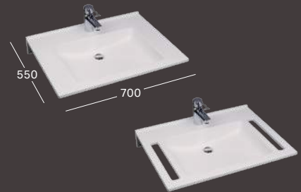
Agilo Waschtisch B 700 / T 550 aus Varicor®, ohne Überlauf, unterfahrbar, DIN 18040 → ohne Ausschnitte → mit Ausschnitten
