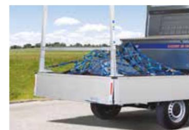
Abbildung zeigt Ladungssicherungsnetz mit optionalem Zubehör
