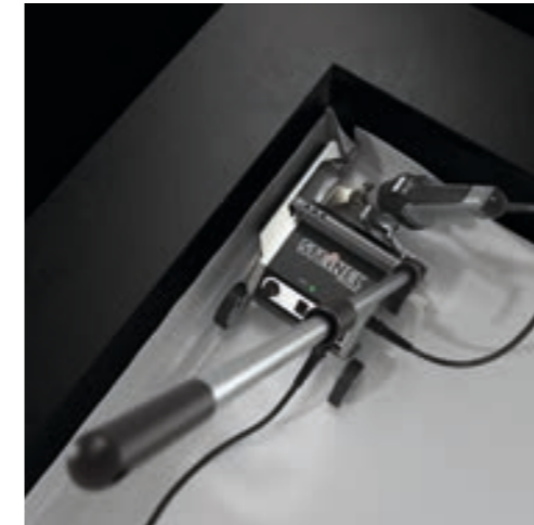
Schweißen bis auf 15 cm an Attika-Ecken
