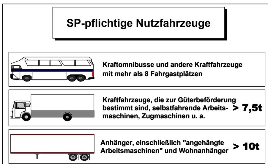
In der SP-Durchführungsrichtlinie gemäß Anlage VIII StVZO werden für die Prüfbereiche die einzelnen Prüfpunkte und möglichen Mängel vorgegeben. Diese Prüfpunkte müssen alle geprüft werden. Sicherheitsrelevante Prüfbereiche sind:
