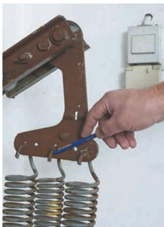
! Die Sicherheit hängt am seidenen Faden: Kein Schutz gegen das Wegspringen der Federn.
