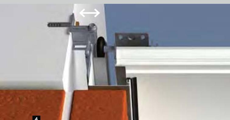
**4** Montage bei nichttragenden Fassaden (Klinker oder Wärmedämmung) mit min. 90 mm bzw. max. 125 mm Seitenanschlag
