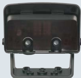
Radar- Bewegungsmelder MWD-C Schnelle und gezielte automatische Toröffnung, richtungserkennend, max. Montagehöhe 7 m, Montage im Tiefkühlbereich möglich bis maximal -22°C, Gehäuse-Schutzart IP 65
