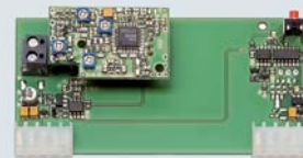
Empfänger HER 1 (1-Kanal) mit potentialfreiem Relais-Ausgang im separaten Gehäuse, ohne Anschlussleitung oder als Aufsteck-Plati- ne im Steuerschrank
