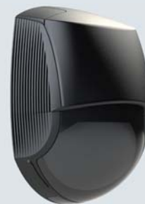
3D Laserscanner Scanprotect Überwachung des Feldes mit sieben schräg angeordneten Laserstrahlen nach dem Prinzip der Lichtlaufmessung, individuelle Auswertungs- möglichkeiten, besonders für den Außeneinsatz geeignet, Gehäuse-Schutzart IP 65
