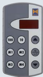
Industrie-Handsender HSI BS zur Ansteuerung von bis zu 1000 Toren, mit Anzeige-Display und extra große Kurzwahl-Tasten zur leichteren Bedienung mit Arbeitshandschuhen, Übertragung der Handsender-Codierungen auf weitere Geräte möglich
