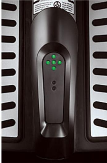
**In dem Moment, in dem Sie auf das Gerät steigen, beginnen fünf Gyroskopsensoren und zwei Beschleunigungssensoren 100mal pro Sekunde das Gelände und die Körperposition des Fahrers zu analysieren.**
