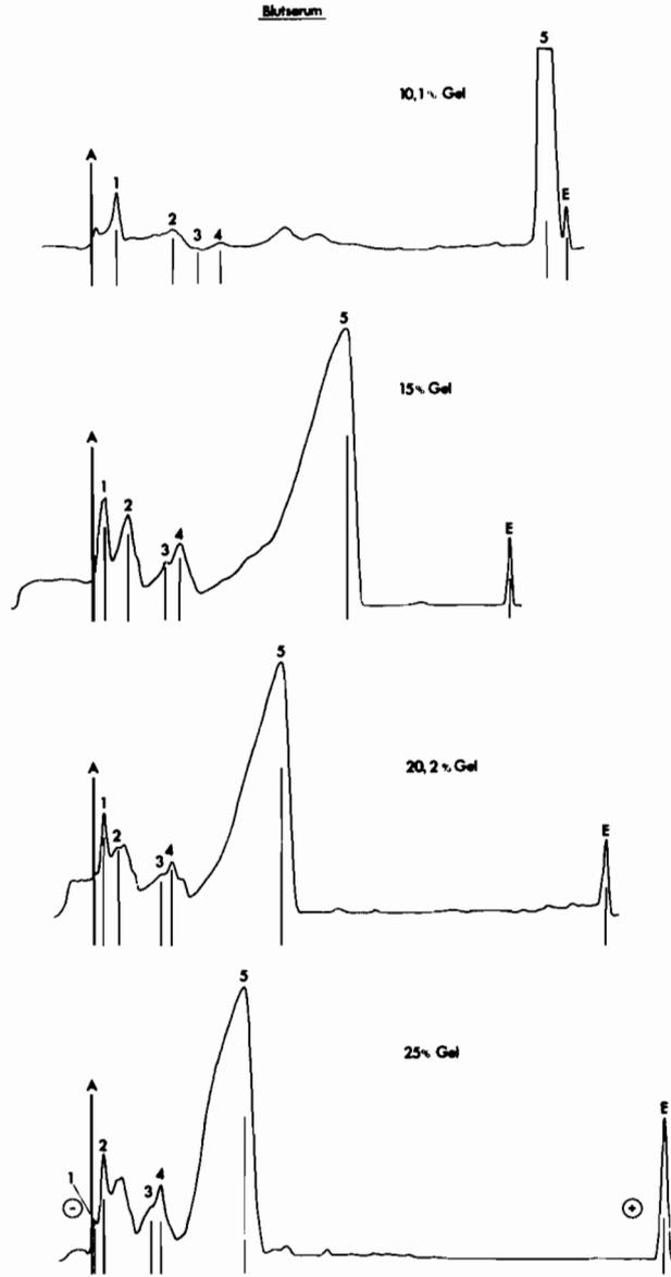
Abb. 7: Elektrophorese von Blutserum am Polyacrylamidgel bei verschiedenen Gelkonzentrationen
