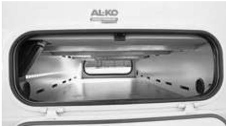
Der 29 Zentimeter hohe, beheizte, isolierte Doppelboden bietet einen durchgehenden, von beiden Fahrzeugseiten sowie von innen aus zugänglichen Stauraum.
