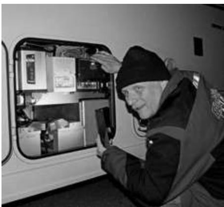
**„Im Servicfach auf der linken Fahrzeugseite sind alle wichtigen Komponenten des Bordnetzes einfach erreichbar und sehr gut geschützt untergebracht. Einige Kabel könnten aber sorgfältiger verlegt sein.“**
