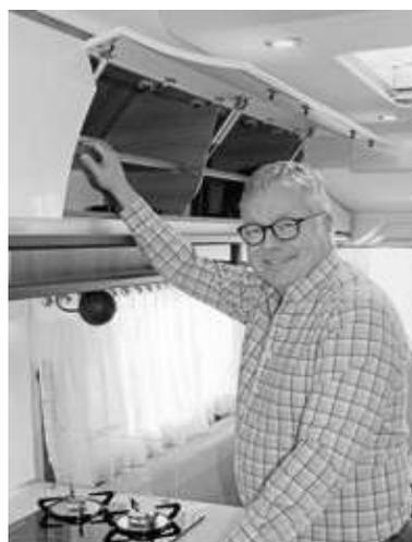
**„Gasdruckdämpfer als Aufsteller, aufwändig geformte Möbelklappen, stabile Zwischenböden, entgratete Umleimer – der Innenausbau des Rapido macht Freude. Doch die Einfassung des Queensbets sollte man ändern.“**
