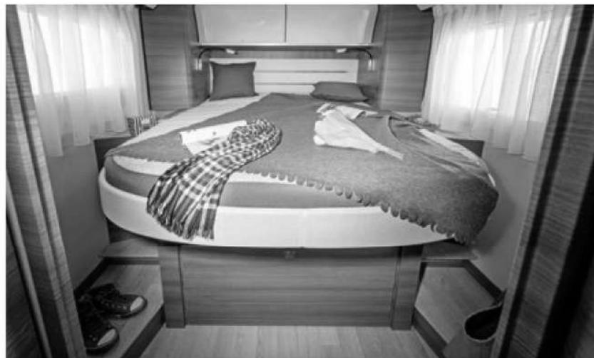
Bei hochgefahrenem Queensbett wird die Heckgarage höher. Per Knopfdruck fährt das Bett bei sich aufstellendem Kopfende Richtung Heck. So vergrößert sich der Durchgang am Fußende.
