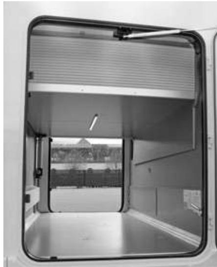
Die Heckgarage bei abgesenktem und hochgefahrenem Queensbett. Die beiden Klappen rechts in der Vorderwand gewähren Zugriff auf den Frischwassertank. Der WC-Schacht ist nicht abgedichtet, aber verschalt.
