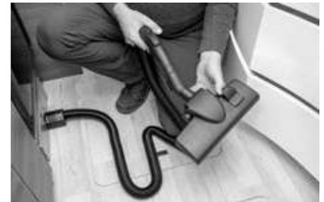
Ebenfalls Serie: ein wirkungsvoller 230-V-Staubsauger mit zentralem Anschluss unterm Kühlschrank.
