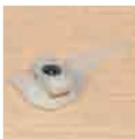
Bei Kälte zieht sich Aluminium stärker zusammen als Holz. Das sorgt für Spannung auf dem Rahmen. Dem beugen wir vor, indem wir die Aluschalen auf Gleitkupplungen – wie auf einem Schienensystem – lagern. Au-
