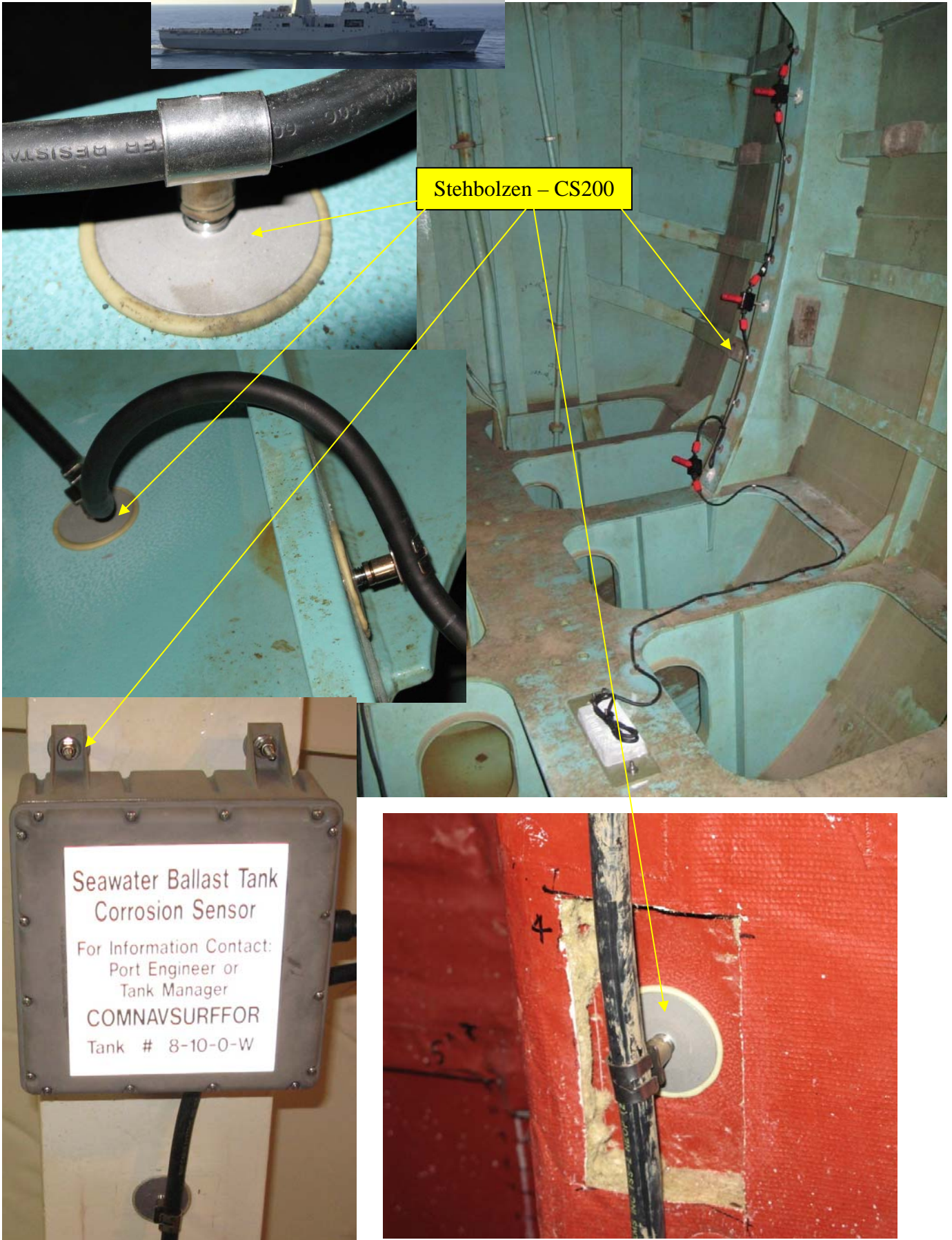
Bild 11 – Geklebte Befestigungen für Korrosionsmesssensoren und Überwachungseinheit im Ballasttank
