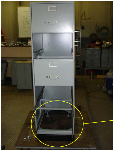
Bild 3 – Aktenschrank befestigt mit CB9522 Stehbolzen, vorbereitet für einen Aufprallstoßtest
