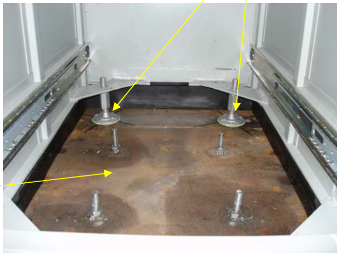
Bild 3 – Aktenschrank befestigt mit CB9522 Stehbolzen, vorbereitet für einen Aufprallstoßtest
