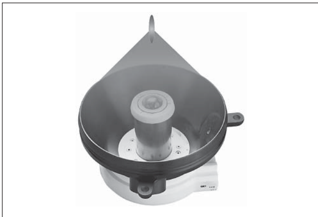
Abbildung 12: Elektromagnetische Stoßwellenerzeugung, Zylinderspule und Paraboloidreflektor. Eine Spule wird um einen Hohlzylinder gewickelt und mit einer Isolierschicht und einer leitfähigen Membran abgedeckt. Ein Stromstoß erzeugt abstoßende elektromagnetische Kräfte, die der Geometrie der Anordnung entsprechend eine zylindrische Druckwelle quer zur Zylinderachse abstrahlt. Durch Reflexion am Paraboloidreflektor wird die Welle in eine konvergente Kugelwelle transformiert und in der Therapiezone konzentriert.
