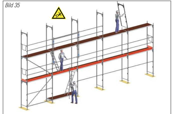
Die Stellrahmen der obersten Gerüstlage sind wie dargestellt zu montieren. Nach der Stellrahmen-Montage ist der Geländerholm einzusetzen und zu verkeilen. Anschließend Stirngeländer befestigen und Bordbretter installieren. Anker sind fortlaufend mit dem Gerüstaufbau einzubauen, ebenso Vertikal diagonalen.
