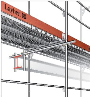
Bild 48: Verankerung an horizontalen Balken
