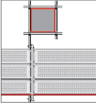
Die Verankerung an Betonstützen oder ummantelten Stützen kann durch eine Rohrkupplungskonstruktion erfolgen. Alle Kupplungen fest anziehen.
