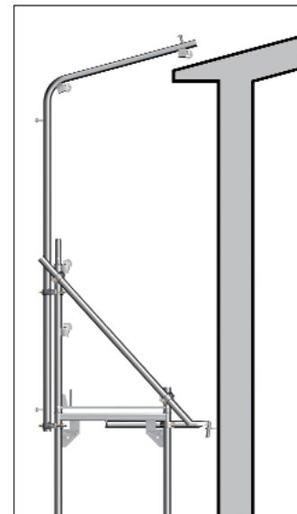
Bild 103: Einbau Wetterschutzstütze
