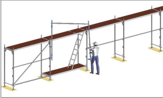
Bild 14: Montage des MSG im Aufstiegsfeld
