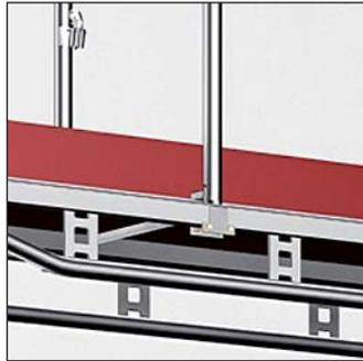
Bild 84: Detail U-Doppelriegel mit Rohrverbinder
