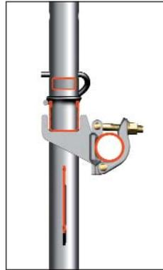
Bei Verwendung von Innen- und Außenkonsolen kann der Gerüsthalter mit 2 Knotenblech-Kupplungen befestigt werden.
