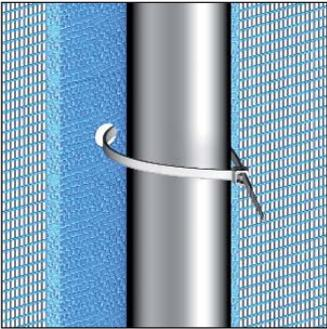
Ist eine Bekleidung mit Netzen vorgesehen, sind Layher Gerüstnetze zu verwenden. Diese haben die erforderliche Luftdurchlässigkeit und den richtigen Abstand der Ösenbänder. Die Befestigung erfolgt durch Layher Einmalbinder am Außenstiel des Stellrahmens im Abstand von maximal 20 cm.
