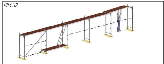
**Achtung:** Die Verankerung ist fortlaufend mit dem Gerüstaufbau einzubauen. Siehe hierzu Kapitel 6, Seite 14. Bei nur einer Gerüstlage, jeden zweiten Stellrahmen verankern. Bei einlagigem Dachfanggerüst jeden Stellrahmen verankern. Verankerung fortlaufend durchführen.
