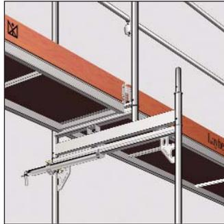
Bild 95: Verwendung Reduzierstück
