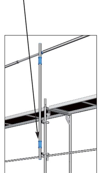
Bild 12 und 13: Anschluss des Montagepfostens an einen Blitz-Stellrahmen
