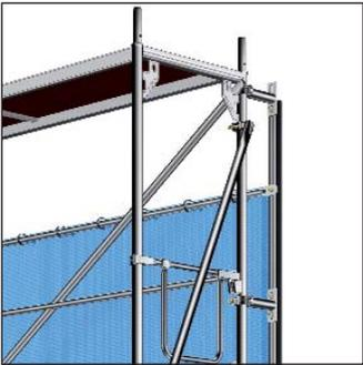
Bild 118: Aufbaubeispiel Kederplanensystem
