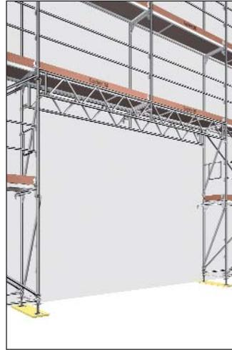
Bild 85: Gitterträgerüberbrückung
