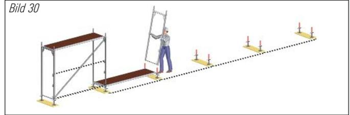
12. Mit Wasserwaage die waagerechte Lage prüfen und ggf. nachspindeln.
