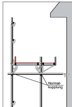
Gerüsthalter werden mit 2 Normalkupplungen am inneren und äußeren Ständer angeschlossen, dabei wird der Anker in die Ringschraube eingeführt. Werden Konsolen verwendet, muss der Anker unterhalb der Knotenbleche angeschlossen werden. Die hierbei entstehende eingeschränkte Durchgangshöhe ist zu beachten.
