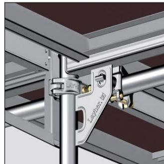
Bild 43: Detail Knotenblechkupplung
