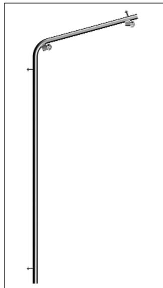
Bild 102: Wetterschutzstütze
