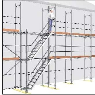
Bild 53: Verbindung zum Hauptgerüst
