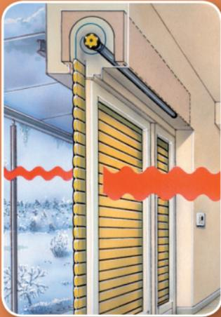
Im herunter gefahrenen Zustand schließen moderne Rollläden Luftpolster zwischen Rollladeninnenseite und Fenster ein. Dieses Luftpolster wirkt nachts als Dämmschicht und verringert den Wärmeverlust entscheidend. Mit einer Automatikfunktion versehen, schließt sich der Rollladen immer rechtzeitig – auch wenn die Bewohner nicht im Haus sind.
