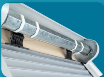
Starre Verbinder aus glasfaser-verstärktem Kunststoff verbessern die einbruchhemmende Wirkung der Rollläden im Vergleich zu Metallfedern erheblich. Sie verbinden den Rollladenpanzer fest mit der Welle.
