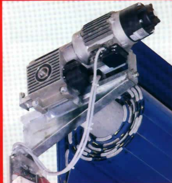
Bei großen und häufig betätigten Industrie-Toren sind Aufsteck-Getriebemotoren notwendig. Diese liefern wir in allen Stärken mit stabilen Anrollkonsolen. Hier werden dann auch anstatt der 125 mm achtkant-Wellen massive Rund- wellen in angepasstem Durchmesser eingesetzt.
