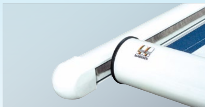
Abgerundeter Umlenkkopf aus stabilem Aluminiumguss, Führungsschiene zum Schutz des Zugbandes mit integrierter Bürstendichtung
