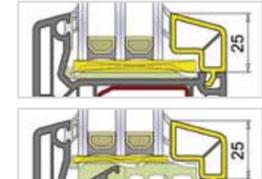
Identische Glasleisten für Flügel- und Festverglasung ermöglichen gleiche Optik ohne Zusatzprofile
