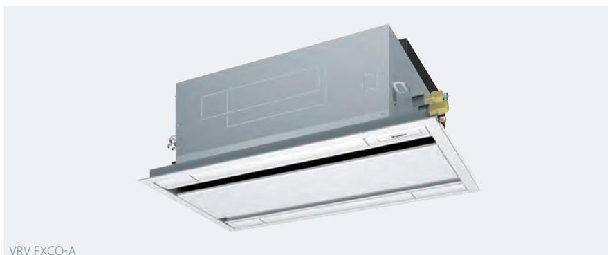
Ansaugen mittig, ausblasen an den beiden Längsseiten. Dabei sorgt eine horizontale Schwenkautomatik für gleichmäßige Luftverteilung und vermeidet gleichzeitig ein Verschmutzen der Decke.
