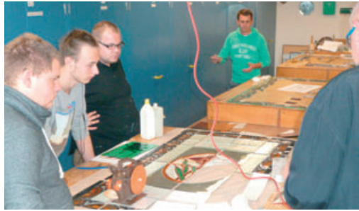
AUFBLEIEN EINES FENSTERS. RECHTS: MEISTER EHLERS ERKLÄRT PUNKTE, DIE BEI DER ANFERTIGUNG EINER TIFFANY-ARBEIT ZU BEACHTEN SIND.
