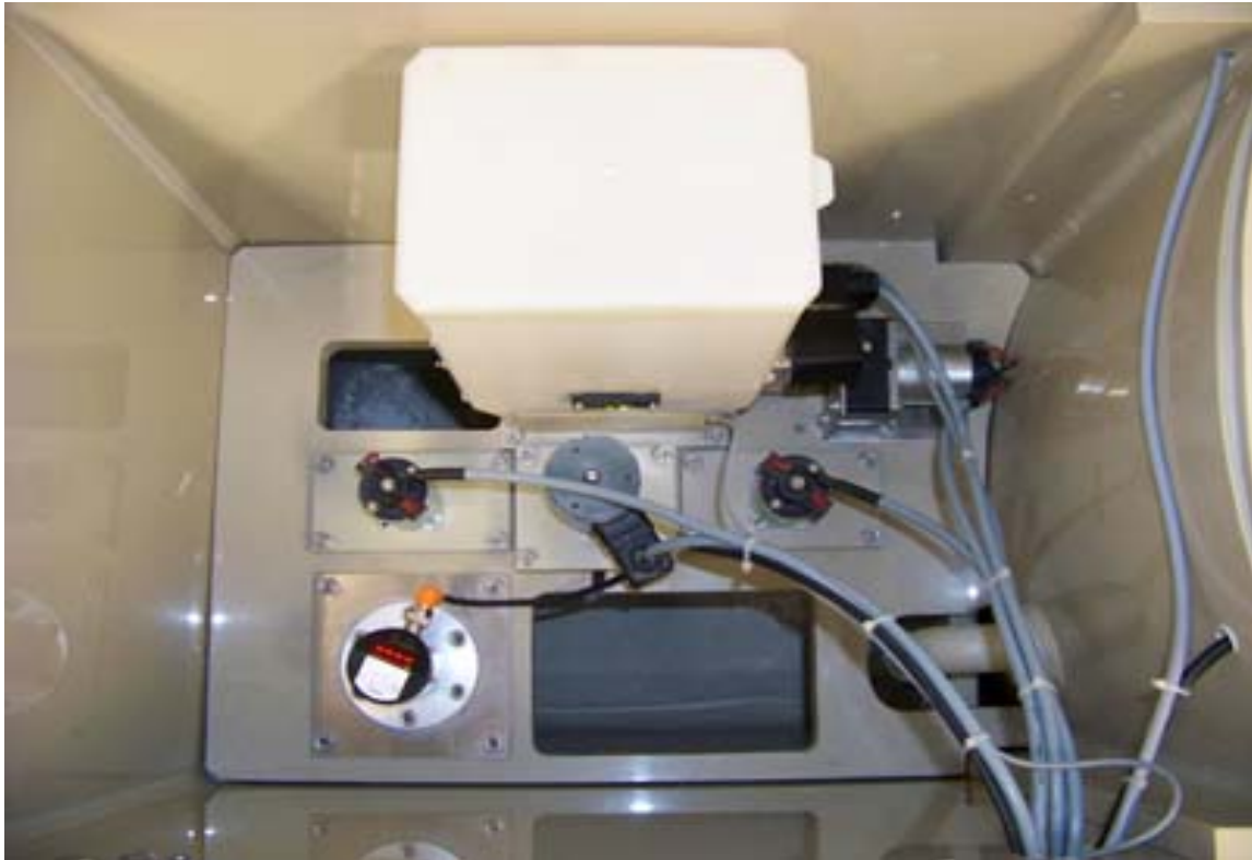
Reaktionsbehälter, mit Dosierer, Rührwerksmotoren, Ablasstmagnet, Sensor Füllstand, Sensor Überfüllung Alarm
